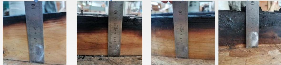
火灾后墙体内拼缝处木龙骨炭化深度
