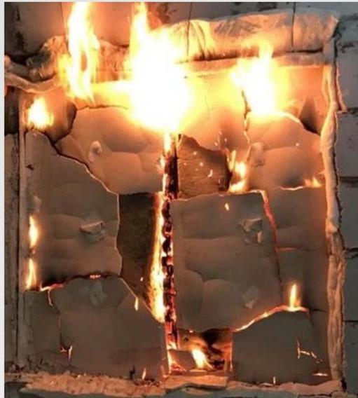
火灾中轻木墙体石膏板开裂脱落
