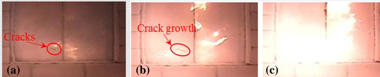
受火22、28和40min后单层木基石膏复合材料覆面墙体试验现象
