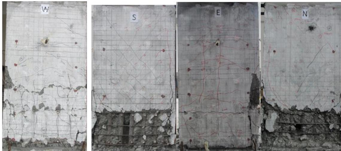
灌浆套筒试件S3裂缝分布图
