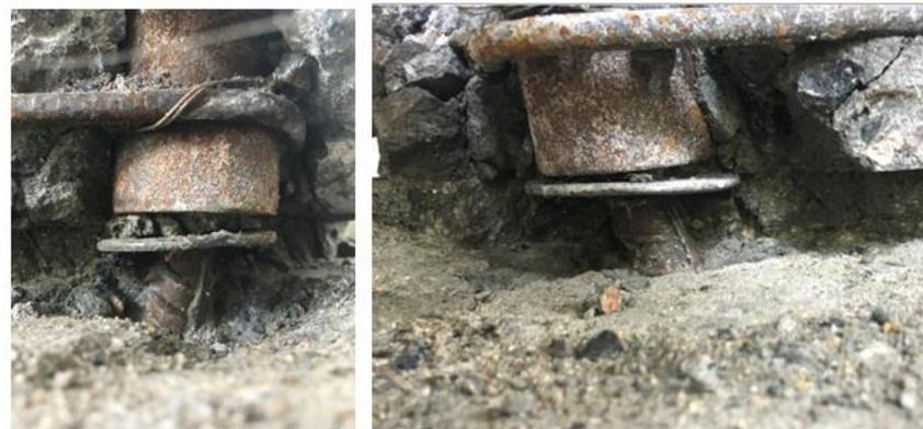
(b) 套筒底部纵筋应变渗透 (c) 套筒下方纵筋受剪变形
