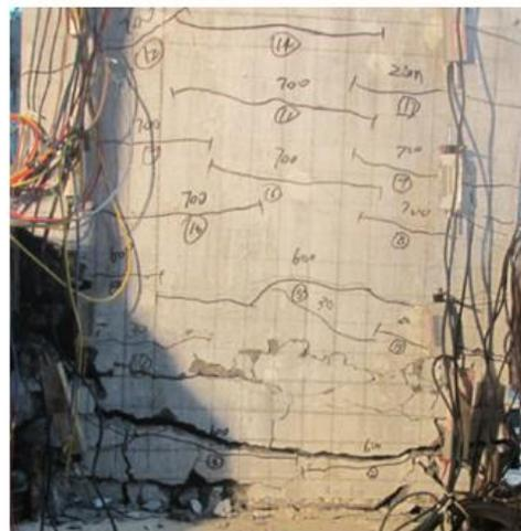
(c) 混凝土严重破裂
