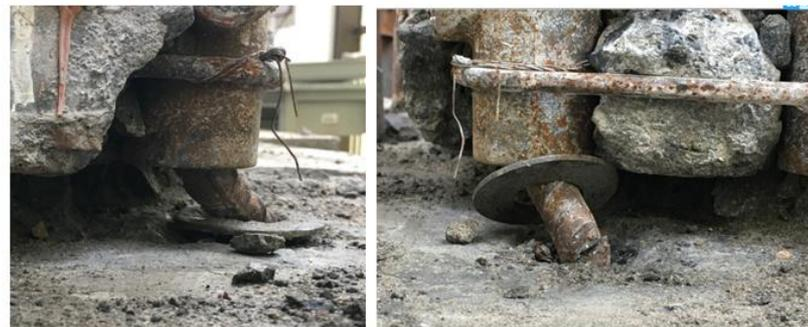
(d) 套筒下方纵筋剪断
