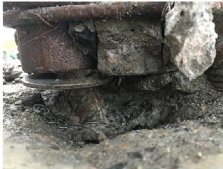
(b) 套筒下方纵筋发生应变渗透和剪切变形
