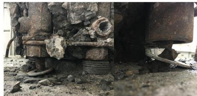
(b) 套筒下方纵筋混凝土破碎 (c) 套筒下方纵筋断裂
