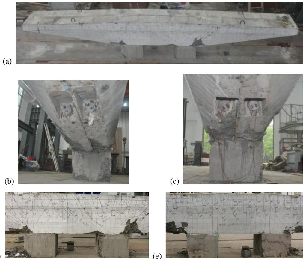
PB-2 分片预制盖梁试件破坏形态：
